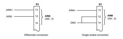
Figure 24 - AIN0 analog input wiring
